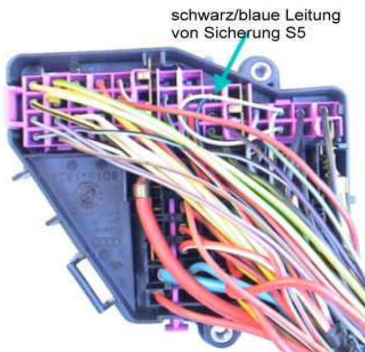
Signalleitung anschließen (letztes Kabel):
