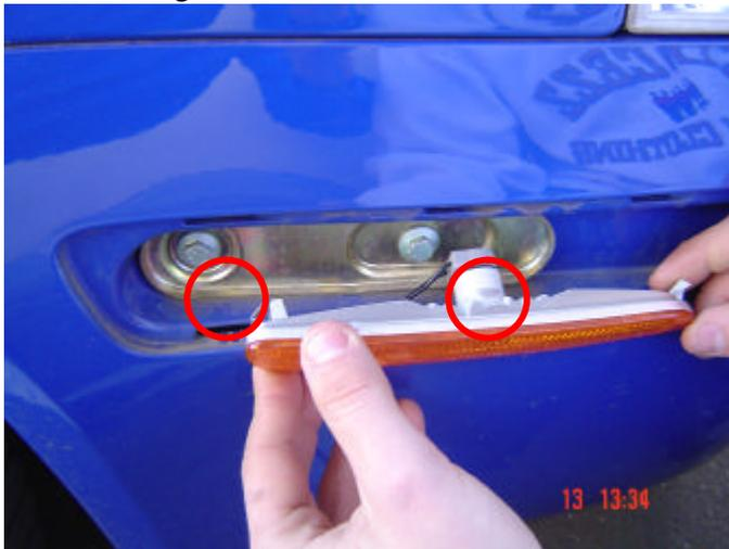
Nun kann man den Halter bereits bearbeiten, ich habe einfach neben der rechten Schraube ein 23er Loch mit einer Standbohrmaschine gebohrt, dann hat es schon gepasst.
