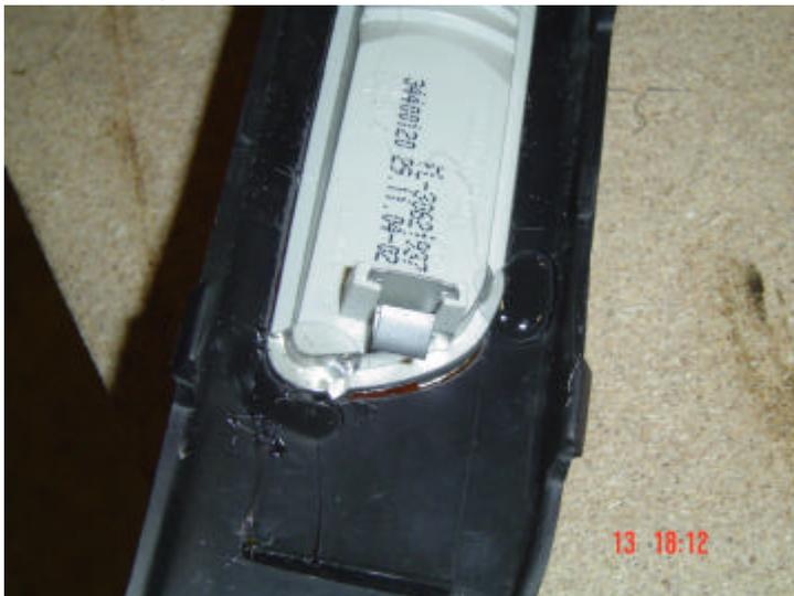
Wenn dieser trocken ist, sollte man Rundrum eine dicke Naht mit dem Silikon (oder Scheibenkleber) ziehen.
