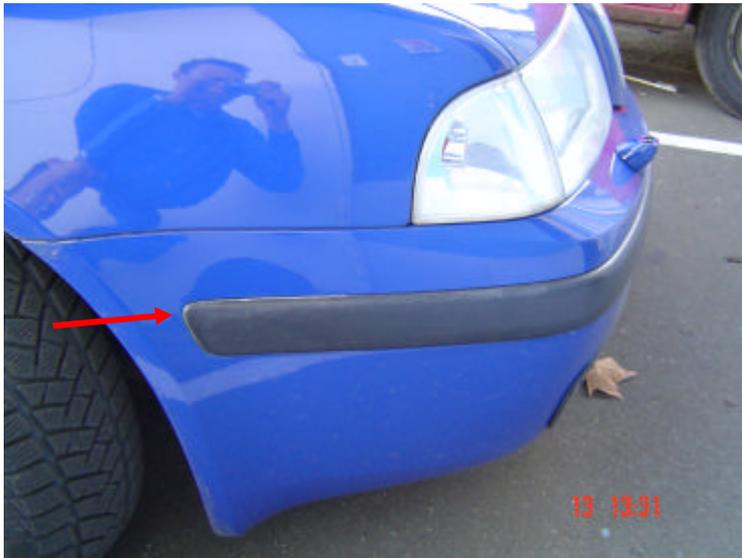
Nun die SML ausrichten, am besten so, dass sich die Lampenfassung kurz vor der Schraube des Stoßstangenhalters befindet. Nun das Maß von der Außenkante der SML bis der der Aussparung für die Rammschutzleiste messen und notieren. (Das Maß betrug bei mir rund 55mm)
