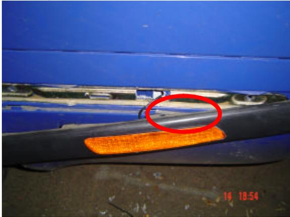
Wenn auch hinten der Halter und die Stoßstange ausgeschnitten ist (den Halter wieder montieren), muss auch hier das Kabel verlängert werden. Ich habe der Einfachheit halber beide Kabel rechts durch die Lüftungklappen gezogen.
