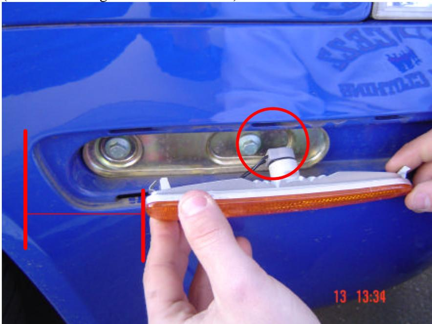
Nun mit Hilfe einer SML eine Schablone fertigen, hierzu eignet sich auch der Verpackungskarton:
