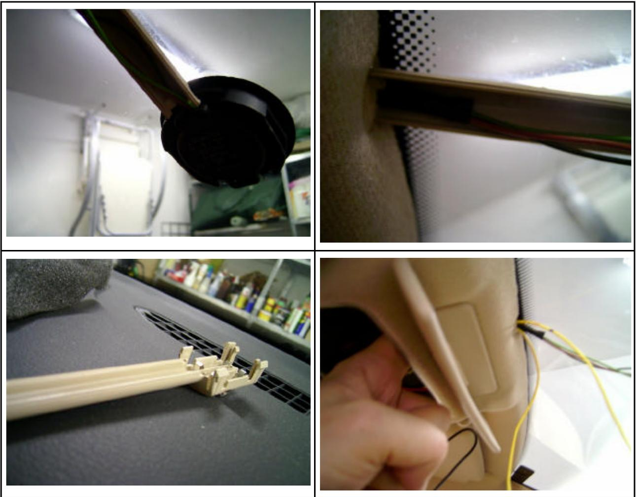
Da die Kabeldurchführung in den Dachhimmel sehr klein war, musste ich den unteren Kabelkanal auch noch lösen, was mit einigem Rangieren auch gelang. Der untere Teil ist mechanisch nicht befestigt und liegt lediglich an der Scheibe an.
