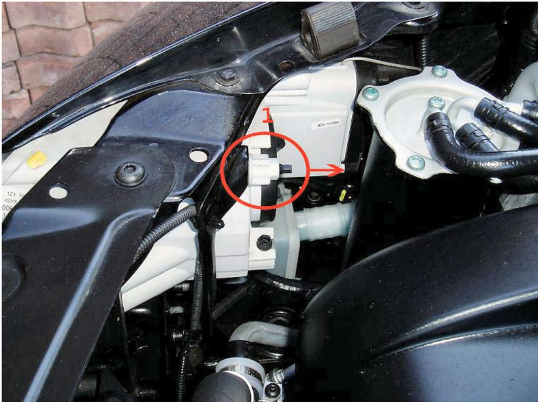
Ist die Mutter gelöst, muss der Hebel für die Scheinwerferverriegelung (Bild 2, Schritt 1) nach rechts in Pfeilrichtung bis zum Anschlag herausgezogen werden. Danach den Scheinwerfer vorsichtig wie in Bild 2, Schritt 2 gezeigt herausziehen...fertig.
